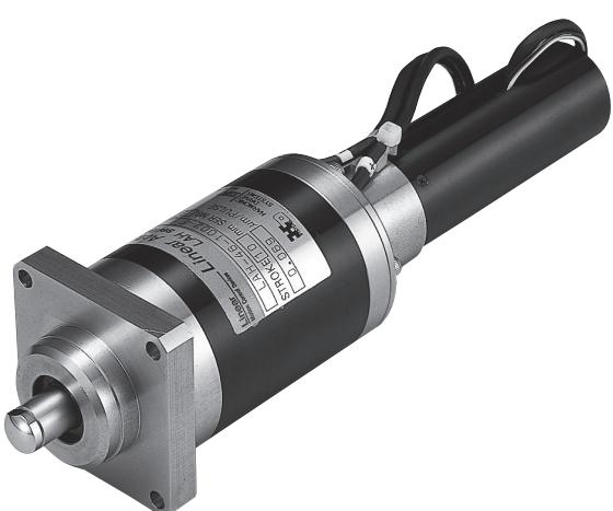
LAH-46 シリーズは最大 390 N の推力と分解能 0.069 μm が得られるリニアアクチュエータです。駆動モータは、DC サーボモータまたはステッピングモータのいずれかを選択できます。
