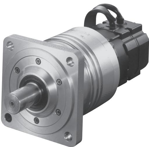
RSFシリーズは、精密制御用減速機ハーモニックドライブ<sup>®</sup>とACサーボモータを組み合わせた、小型・高トルク・高回転精度でシャフト出力のACサーボアクチュエータです。
