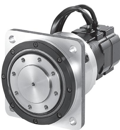
RKFシリーズは、精密制御用減速機ハーモニックドライブ®とACサーボモータを組み合わせた、小型・高トルク・高回転精度でフランジ出力のACサーボアクチュエータです。このRKFシリーズの性能を充分に引き出す専用サーボドライバとのセットにより、高回転精度でコンパクトな機械装置を実現します。
